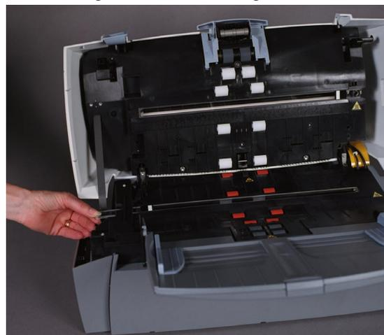
2. Usando uma chave Phillips, solte o parafuso da guia inferior de imagem e deslize-a para fora do braço, removendo-a do scanner.
