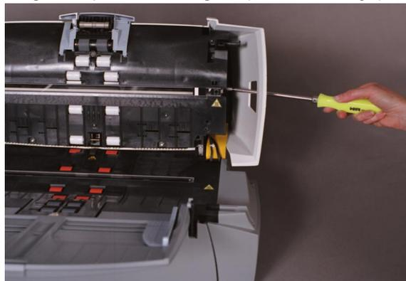
4. Puxe a guia de imagem cuidadosamente pela extremidade e remova-a do scanner lentamente.
