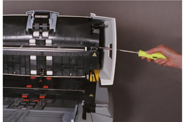
6. Puxe a guia de imagem pela extremidade e remova-a do scanner lentamente.
