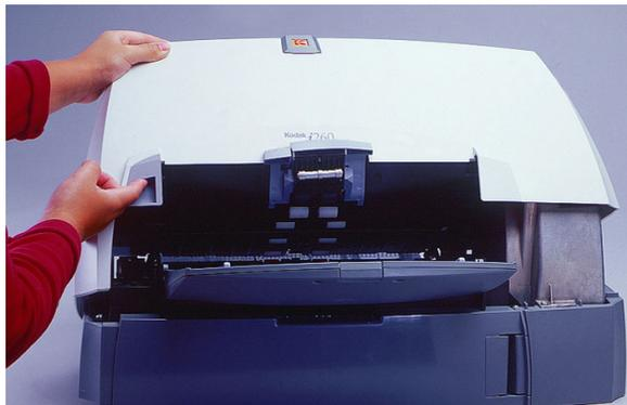
5. Remova o módulo de separação empurrando-o para baixo e levantando-o.
