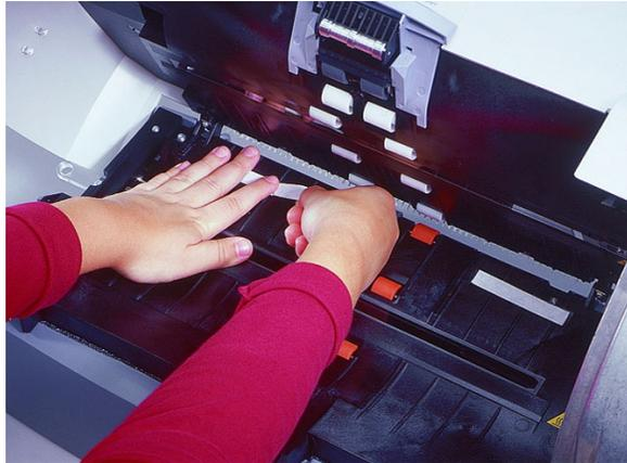
14. Baixe a porta do scanner e empurre-a com firmeza até que ela se reencaixe.
