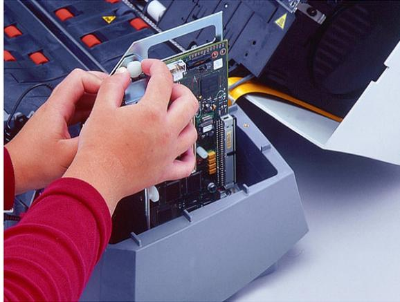
7. Verifique se a placa da impressora está bem encaixada e presa.
