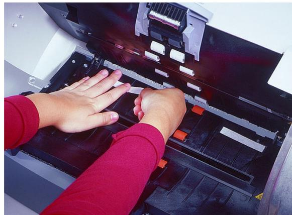
8. Baixe a porta do scanner e empurre-a com firmeza até que ela se reencaixe.
