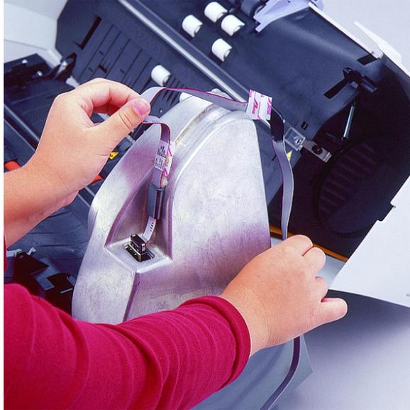
13. Remova a película do primeiro gancho auto-adesivo fixado ao cabo da impressora.
