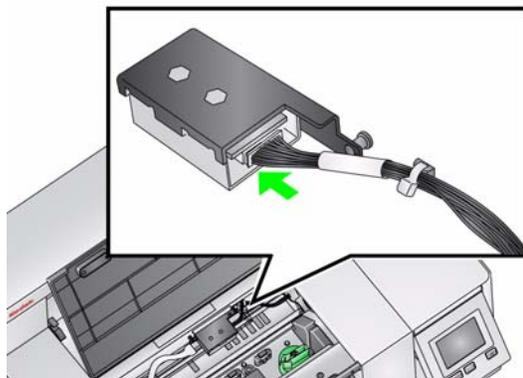
16. Fissare il supporto della stampante di tipo avanzato sul supporto verde come indicato di seguito.
