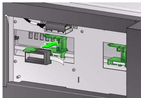
5. Collegare il cavo della stampante dal supporto nel lato destro della scheda dei circuiti della stampante. Verificare che il lato in rame del cavo della stampante sia rivolto verso l'alto.
