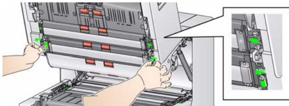
3. Installare la nuova guida immagini della stampante di tipo avanzato e serrare le viti in modo che la guida immagini sia fissata saldamente in posizione, *non forzare*.
