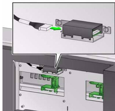
4. Fissare il supporto della stampante di tipo avanzato sul supporto verde come indicato di seguito.
