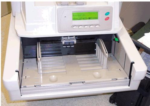
3. 将手动进纸器放到升降台托盘的顶部，使手动进纸器中的插槽与侧导轨对齐。将手动进纸器完全插入到位。
