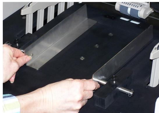
7. 调整侧导轨后，将螺丝拧紧。
